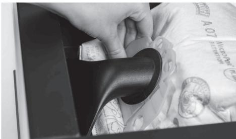
Надавите на мешок вниз и в направлении внутрь прибора от всасывающего отверстия, при этом закройте отверстие в мешке с помощью специального механизма.
